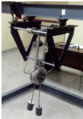
شکل ۱: شماتیک واقعی و دینامیکی دستگاه هیبریدی ضدگالوپینگ
